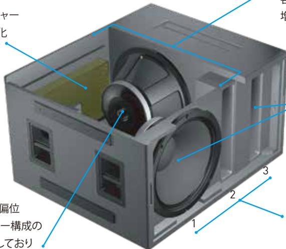
2台のウーファーは、ベントチャンバーを共有しています。各ウーファーへのDSP信号は、チャンバー内の有効容積を増加させます。
