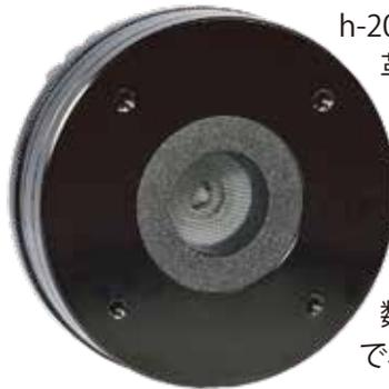
h-208アクティブ2ウェイシステムは革新的なTruextentベリリウムダイアフラムを核としたコンプレッションドライバーを採用しています。ベリリウムは、剛性と質量比が非常に高く、機械的な変形を大幅に低減し、共振周波数を可聴域外にシフトさせることで、アルミやチタンを凌駕しています。
