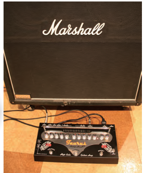
↑接続は、ギター→ストンプヘッド→スピーカー・キャビネット。ストンプヘッドからキャビネットまでは、スピーカー・ケーブルで接続することをお忘れなく!
