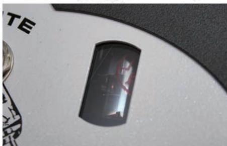
▲12AX7A真空管を1本搭載し、トランジスタと組み合わせて出力するハイブリッド・アンプとなっている
