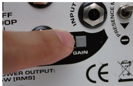
▲リア・パネルにあるゲイン・スイッチを押すと、入力ゲインが+6dBブーストされる
