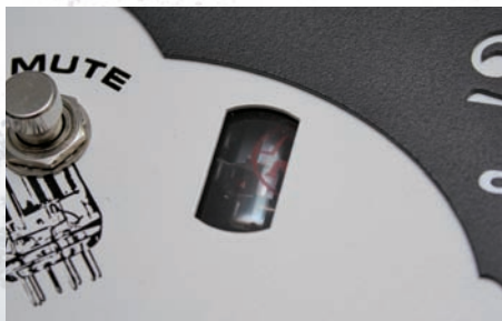
▲基本的なスペックは、High GainもClassicも同様だ。もちろん、こちらも真空管を使ったハイブリッド・タイプ
